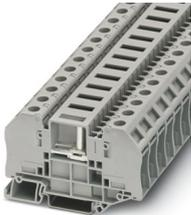
Messwandler-Trennklemme, Achtung: bei nicht isolierten Kabelschuhen ist die Streckenverlängerung BE-RT... (siehe Zubehör) einzusetzen!, mit Prüfbuchschrauben zur Aufnahme von Prüfsteckern, Nennspannung: 500 V, Nennstrom: 41 A, 1. Etage, Anschlussart: Bolzenanschluss, Bemessungsquerschnitt: 6 mm<sup>2</sup>, Montage: NS 35/7,5, NS 35/15, Farbe: grau
