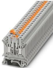
Messertrennklemme, Nennspannung: 500 V, Nennstrom: 16 A, Anschlussart: Schraubanschluss, Bemessungsquerschnitt: 1,5 mm<sup>2</sup>, Querschnitt: 0,2 mm<sup>2</sup> - 6 mm<sup>2</sup>, Montage: NS 35/7,5, NS 35/15, NS 32, Farbe: grau
