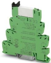
PLC-INTERFACE für Bahnanwendungen, bestehend aus Grundklemme mit Zugfederanschluss und steckbarem Miniaturrelais mit Leistungskontakt, Bereich:  $0,7 \times U_N$  bis  $1,25 \times U_N$ , Temperaturklasse TX:  $-40\text{ °C}$  bis  $+70\text{ °C}$ , 1 Wechsler, Eingangsspannung 24 V DC
