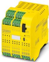
Frei konfigurierbares Sicherheitsmodul mit 20 sicheren Ein- und 4 sicheren Ausgängen, 4 Melde-, 2 Takt- und 2 Masseschaltausgänge, Diagnose über Bus-Gateways möglich, bis zu SIL 3, Cat. 4/PL e, SIL 3, EN 50156, steckbare Push-in-Klemme
