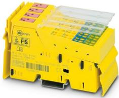
Sicherheitsgerichtetes, dezentrales digitales Ausgabemodul, Schutzart IP20 der Produktfamilie Inline. Das Modul verfügt über vier sichere digitale Ausgänge bei zweikanaliger Belegung oder acht sichere digitale Ausgänge bei einkanaliger Belegung.
