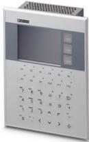
Key-Panel, 320 x 240 Pixel (QVGA), 5 Graustufen, Arm9™, 200 MHz, 2x USB Host 2.0, 1x Ethernet (10/100 MBit/s), RJ45, Windows® CE 5.0, Visu+ / AX OPC Server, ohne Bussystem.
