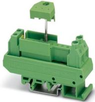
Das UMK-1 OM-R/AMS ist Verdrahtungsschnittstelle und Koppellebene in einer Einheit: Statusanzeige, Verpol- und Überspannungsschutz am Eingang, Bestückungsmöglichkeiten mit Solid-State-Relais bis 350 V DC/1 A bzw. 480 V AC/5 A
