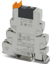
PLC-INTERFACE für Ausgabefunktionen, bestehend aus Grundklemme PLC-BSC.../ACT mit Schraubanschluss und steckbarem Miniatur-Solid-State-Relais, zur Montage auf Tragschiene NS 35/7,5, 1 Schließer, Eingang: 24 V DC, Ausgang: 3 ... 33 V DC/5 A
