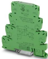
PLC-Solid-State Relais mit Zugfederanschluss, zur Montage auf Tragschiene NS 35/7,5, Eingang: 24 V DC, Ausgang: 3-33 V DC/10 A
