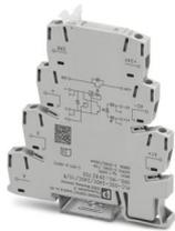
PLC-INTERFACE mit Rückmeldekontakt, bestehend aus Grundklemme mit Schraubanschluss und integriertem Miniatur-Solid-State-Relais, zur Montage auf Tragschiene NS 35/7,5, 1 Schließer, Eingang: 24 V DC, Ausgang: 3 ... 33 V DC/10 A
