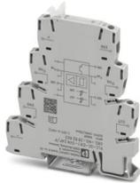
PLC-INTERFACE für NAMUR-Anwendungen, bestehend aus Grundklemme PLC-BSC.../21 mit Schraubanschluss und integrierter Schaltung, zur Montage auf Tragschiene NS 35/7,5, Ausgang plusschaltend, Versorgungsspannung 24 V DC
