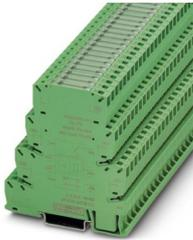
PLC-INTERFACE für NAMUR-Anwendungen, bestehend aus Grundklemme PLC-BSP.../21 mit Zugfederanschluss und integrierter Schaltung, zur Montage auf Tragschiene NS 35/7,5, minusschaltend, 1 Schließer, Eingangsspannung 24 V DC
