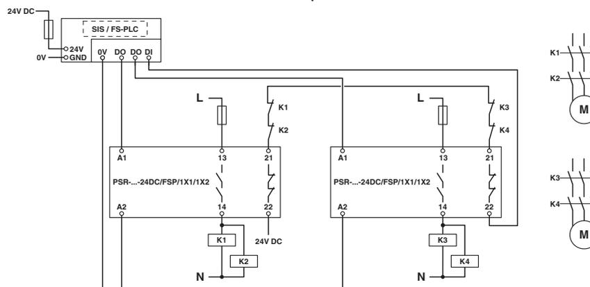
Zweikanaliger Anschluss mit Einbindung des Rückmeldestrompfades
