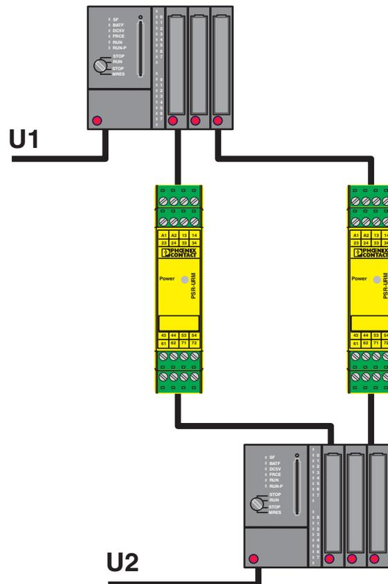
Zuverlässiger Signalaustausch zwischen zwei Systemen mit Rückmeldefunktion.
