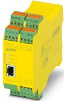
2-kanaliger Drehzahl- und Stillstandswächter bis SIL 3 oder Cat. 4, PL e nach EN ISO 13849, 4 Schließer, geeignet für den Anschluss von Inkrementalencodern und Initiatoren, Breite: 45 mm, steckbare Push-in-Klemme
