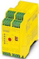
Sicherheitsrelais zur Not-Halt- und Schutztürüberwachung bis SIL 3 oder Cat. 4, PL e nach EN ISO 13849, 1- oder 2-kanaliger Betrieb, automatische oder manuelle Aktivierung, 3 Schließer, 1 Öffner, 2 Schließer abfallverzögert 0,2 s ... 300 s, steckbare Push-in-Klemme
