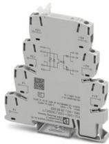
PLC-INTERFACE, integriertes Solid-State-Relais, mit Schraubanschluss, zur Montage auf Tragschiene NS 35/7,5, Eingang: 12 V DC, Ausgang: 12-300 V DC/1 A
