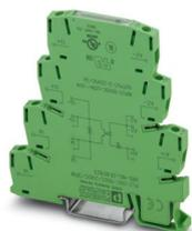
PLC-INTERFACE für Bahnanwendungen, bestehend aus Grundklemme mit Schraubanschluss und integriertem Miniatur-Solid-State-Relais, Bereich:  $0,7 \times U_N$  bis  $1,25 \times U_N$ , Temperaturbereich:  $-25\text{ °C}$  bis  $+70\text{ °C}$ , 1 Schließer, Eingang: 110 V DC, Ausgang: 3-33 V DC/3 A
