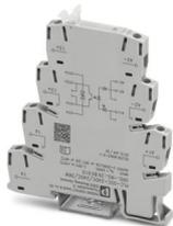
PLC-INTERFACE für Bahnanwendungen, bestehend aus Grundklemme mit Schraubanschluss und integriertem Miniatur-Solid-State-Relais, Bereich:  $0,7 \times U_N$  bis  $1,25 \times U_N$ , Temperaturbereich:  $-25\text{ °C}$  bis  $+70\text{ °C}$ , 1 Schließer, Eingang: 24 V DC, Ausgang: 3-33 V DC/3 A
