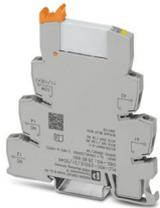
PLC-INTERFACE gegen Störströme bzw. Störspannungen auf der Steuerseite, bestehend aus Grundklemme PLC-BSC.../21 mit Schraubanschluss und steckbarem Miniaturrelais mit Leistungskontakt, 1 Wechsler, Eingangsspannung 230 V AC
