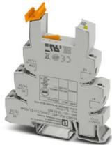
14 mm PLC-Grundklemme gegen Störströme bzw. Störspannungen auf der Steuerseite mit Schraubanschluss, ohne Relais- oder Solid-State-Relaisbestückung, zur Montage auf Tragschiene NS 35/7,5, mit integriertem RCZ-Filter, 2 Wechsler, Eingangsspannung 230 V AC
