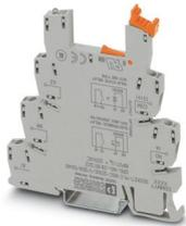
6,2 mm PLC-Grundklemme gegen Störströme bzw. Störspannungen auf der Steuerseite mit Schraubanschluss, ohne Relais- oder Solid-State-Relaisbestückung, mit Sensor-Versorgungsspannungsverteilung (BB), 1 Schließer, Eingangsspannung 120 V AC
