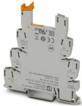
6,2 mm PLC-Grundklemme gegen Störströme bzw. Störspannungen auf der Steuerseite mit Schraubanschluss, ohne Relais- oder Solid-State-Relaisbestückung, zur Montage auf Tragschiene NS 35/7,5, mit integriertem RCZ-Filter, 1 Wechsler, Eingangsspannung 120 V AC
