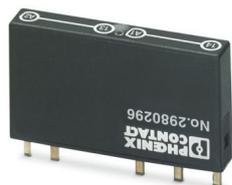
Passive Durchgangsbrücke; statt Relais oder Solid-State-Relais einsteckbar, brückt Klemmstelle (A1 und 14) und (A2 und 13)
