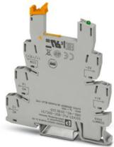
6,2 mm PLC-Grundklemme mit Schraubanschluss, ohne Relais- oder Solid-State-Relaisbestückung, zur Montage auf Tragschiene NS 35/7,5, 1 Wechsler, Eingangsspannung 5 V DC
