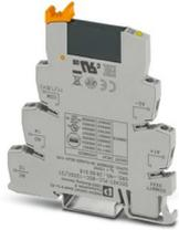
PLC-INTERFACE, bestehend aus Grundklemme PLC-BSC.../21 mit Schraubanschluss und steckbarem Miniatur-Solid-State-Relais, zur Montage auf Tragschiene NS 35/7,5, 1 Schließer, Eingangsspannung: 125 V DC, Ausgang: 24-253 V AC/0,75 A
