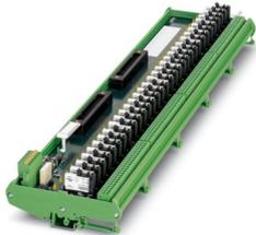
32-kanaliges Relaismodul für Yokogawa digitale Ausgabemodule ADV 551 und ADV 561. Redundanter Systemanschluss, feldseitig Zugfederanschluss. Steckbare Relais mit Statusanzeige (LED) pro Kanal.
