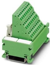
VARIOFACE-Modul, mit Dreistockzugfederanschluss und Flachbandkabel-Steckverbinder, zur Montage auf NS 35/7,5, Polzahl 26
