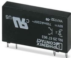
Steckbares Miniatur-Solid-State-Relais, Leistungs-Solid-State-Relais, 1 Schließer, Eingang: 60 V DC, Ausgang: 24-253 V AC/ 0,75 A
