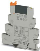
PLC-INTERFACE für Ausgabefunktionen, bestehend aus Grundklemme PLC-BSC.../ACT mit Schraubanschluss und steckbarem Miniatur-Solid-State-Relais, zur Montage auf Tragschiene NS 35/7,5, 1 Schließer, Eingang: 24 V DC, Ausgang: 24 ... 253 V AC/0,75 A
