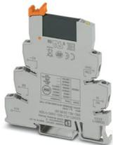
PLC-INTERFACE, bestehend aus Grundklemme PLC-BSC.../21 mit Schraubanschluss und steckbarem Miniatur-Solid-State-Relais, zur Montage auf Tragschiene NS 35/7,5, 1 Schließer, Eingang: 24 V DC, Ausgang: 24-253 V AC/ 0,75 A
