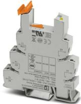
14 mm PLC-Grundklemme für hohe Dauerströme mit Schraubanschluss, ohne Relais- oder Solid-State-Relaisbestückung, zur Montage auf Tragschiene NS 35/7,5, 1 Wechsler, Eingangsspannung 120 V AC/DC
