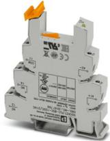
14 mm PLC-Grundklemme für hohe Dauerströme mit Schraubanschluss, ohne Relais- oder Solid-State-Relaisbestückung, zur Montage auf Tragschiene NS 35/7,5, 1 Wechsler, Eingangsspannung 12 V DC
