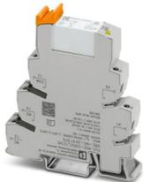
PLC-INTERFACE, bestehend aus Grundklemme PLC-BSC.../21 HC mit Schraubanschluss, und steckbaren Miniaturrelais für hohen Dauerstrom, zur Montage auf Tragschiene NS 35/7,5, Grenzdauerstrom bis 10 A, 1 Wechsler, Eingangsspannung 230 V AC/ 220 V DC
