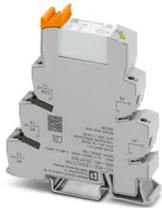
PLC-INTERFACE, bestehend aus Grundklemme PLC-BSC.../21 HC mit Schraubanschluss, und steckbaren Miniaturrelais für hohen Dauerstrom, zur Montage auf Tragschiene NS 35/7,5, Grenzdauerstrom bis 10 A, 1 Wechsler, Eingangsspannung 120 V AC/ 110 V DC
