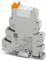
PLC-INTERFACE, bestehend aus Grundklemme PLC-BSC.../21 HC mit Schraubanschluss, und steckbaren Miniaturrelais für hohen Dauerstrom, zur Montage auf Tragschiene NS 35/7,5, Grenzdauerstrom bis 10 A, 1 Wechsler, Eingangsspannung 60 V DC
