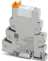
PLC-INTERFACE für hohe Dauerströme, bestehend aus Grundklemme PLC-BSC.../21 HC mit Schraubanschluss und steckbarem Miniaturrelais, zur Montage auf Tragschiene NS 35/7,5, Grenzdauerstrom bis 10 A, 1 Wechsler, Eingangsspannung 24 V DC
