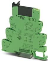
PLC-INTERFACE für Ausgabefunktionen, bestehend aus Grundklemme PLC-BSP.../ACT mit Zugfederanschluss und steckbarem Miniatur-Solid-State-Relais, zur Montage auf Tragschiene NS 35/7,5, 1 Schließer, Eingang: 24 V DC, Ausgang: 3-33 V DC/3 A
