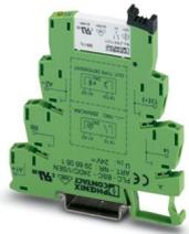
PLC-INTERFACE für Eingabefunktionen, bestehend aus Grundklemme PLC-BSP.../SEN mit Zugfederanschluss und steckbarem Miniaturrelais mit Mehrlagen-Goldkontakt, zur Montage auf Tragschiene NS 35/7,5, 1 Schließer, Eingangsspannung 24 V DC
