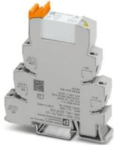
PLC-INTERFACE, bestehend aus Grundklemme PLC-BSC.../21 mit Schraubanschluss und steckbarem Miniaturrelais mit Leistungskontakt, zur Montage auf Tragschiene NS 35/7,5, 2 Wechsler, Eingangsspannung 12 V DC
