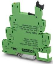
6,2 mm PLC-Grundklemme für Eingabefunktionen mit Zugfederanschluss, ohne Relais- oder Solid-State-Relaisbestückung, zur Montage auf Tragschiene NS 35/7,5, mit Sensor-Versorgungsspannungsverteilung (BB), 1 Schließer, Eingangsspannung 24 V DC
