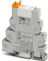
PLC-INTERFACE, bestehend aus Grundklemme PLC-BSC.../21 mit Schraubanschluss und steckbarem Miniaturrelais mit Mehrlagen-Goldkontakt, zur Montage auf Tragschiene NS 35/7,5, 2 Wechsler, Eingangsspannung 230 V AC/220 V DC
