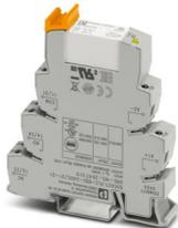
PLC-INTERFACE, bestehend aus Grundklemme PLC-BSC.../21 mit Schraubanschluss und steckbarem Miniaturrelais mit Mehrlagen-Goldkontakt, zur Montage auf Tragschiene NS 35/7,5, 2 Wechsler, Eingangsspannung 24 V DC
