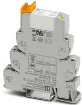
PLC-INTERFACE, bestehend aus Grundklemme PLC-BSC.../21 mit Schraubanschluss und steckbarem Miniaturrelais mit Mehrlagen-Goldkontakt, zur Montage auf Tragschiene NS 35/7,5, 2 Wechsler, Eingangsspannung 24 V AC/DC
