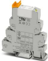
PLC-INTERFACE, bestehend aus Grundklemme PLC-BSC.../21 mit Schraubanschluss und steckbarem Miniaturrelais mit Leistungskontakt, zur Montage auf Tragschiene NS 35/7,5, 2 Wechsler, Eingangsspannung 230 V AC/220 V DC
