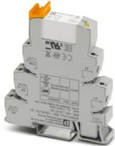
PLC-INTERFACE, bestehend aus Grundklemme PLC-BSC.../21 mit Schraubanschluss und steckbarem Miniaturrelais mit Leistungskontakt, zur Montage auf Tragschiene NS 35/7,5, 2 Wechsler, Eingangsspannung 120 V AC/110 V DC
