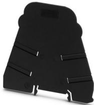
Isolationsplatte, 2 mm dick, ist am Anfang und Ende jeder PLC-Klemmenleiste zu setzen. Weiterhin dient sie zur: optischen Trennung von Gruppen, sicheren Trennung unterschiedlicher Spannungen benachbarter PLC-INTERFACES nach DIN VDE 0106-101, Trennung
