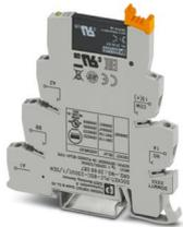
PLC-INTERFACE für Eingabefunktionen, bestehend aus Grundklemme PLC-BSC.../SEN mit Schraubanschluss und steckbarem Miniatur-Solid-State-Relais, zur Montage auf Tragschiene NS 35/7,5, 1 Schließer, Eingang: 230 V AC/220 V DC, Ausgang: 3-48 V DC/100 mA
