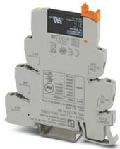
PLC-INTERFACE für Eingabefunktionen, bestehend aus Grundklemme PLC-BSC.../SEN mit Schraubanschluss und steckbarem Miniatur-Solid-State-Relais, zur Montage auf Tragschiene NS 35/7,5, 1 Schließer, Eingang: 24 V DC, Ausgang: 3-48 V DC/100 mA
