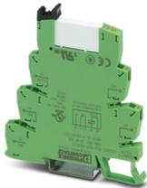
PLC-INTERFACE, bestehend aus Grundklemme PLC-BSP.../21 mit Zugfederanschluss und steckbarem Miniaturrelais mit Mehrlagen-Goldkontakt, zur Montage auf Tragschiene NS 35/7,5, 1 Wechsler, Eingangsspannung 24 V AC/DC
